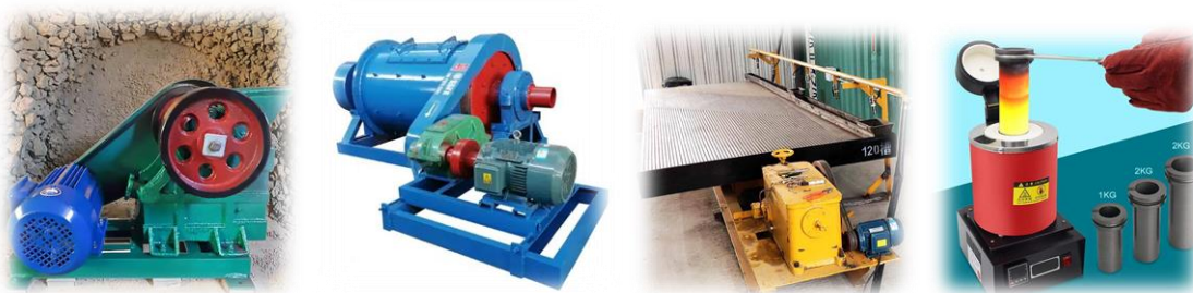
Figura 11.vs4 – Equipamentos de britagem, moagem, concentração e fundição utilizados na Fase 3 do Projeto Ouro Huíla
